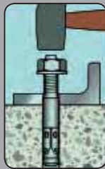
将锚栓用手锤或机动安装工具敲入
